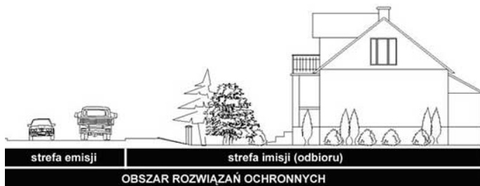
Rys. 6. Strefy emisji i imisji hałasu oraz obszar rozwiązań ochronnych w uniwersalnym podejściu do ochrony przed hałasem drogowym
